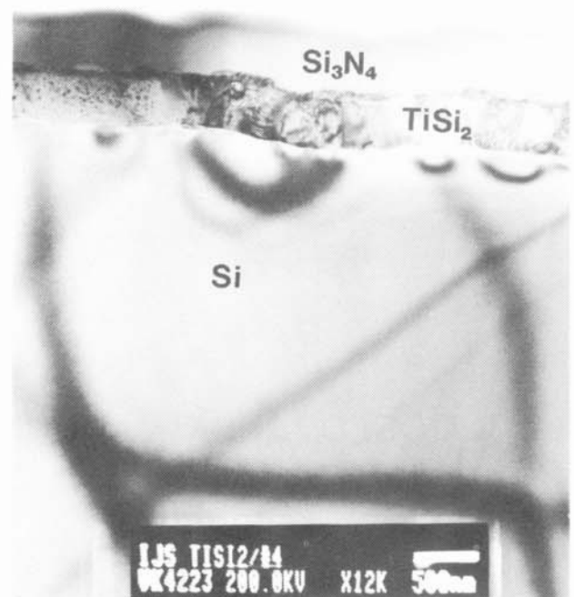
Slika 7: 485 nm debela plast titanovega disilicida, ki jo vidimo na TEM posnetku, je nastala po pregrevanju 200 nm debele plasti titana, ki smo jo napršili na silicijevo podlago (100). Posnetek je bil narejen na Jeol-ovem elektronskem mikroskopu (avtor posnetka dr.V.Kraševac) /5/.
