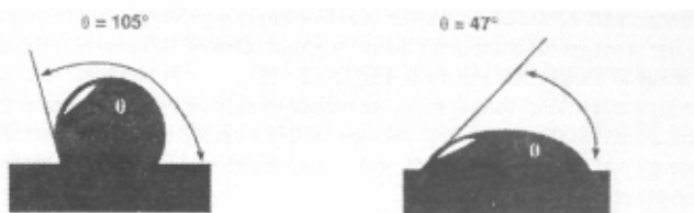
Slika 1: Kontaktni kot vodne kapljice na površini z veliko površinsko energijo (levo) in na površini z majhno površinsko energijo (desno)
