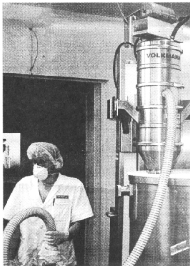
Slika 2: Prenos (transport) prahu iz soda v separator nato v mešalnik v farmacevtski industriji
