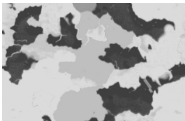
Slika 2: Luščenje volframskih tankih plasti zaradi notranjih napetosti (avtor posnetkov dr. M. Stubičar)
