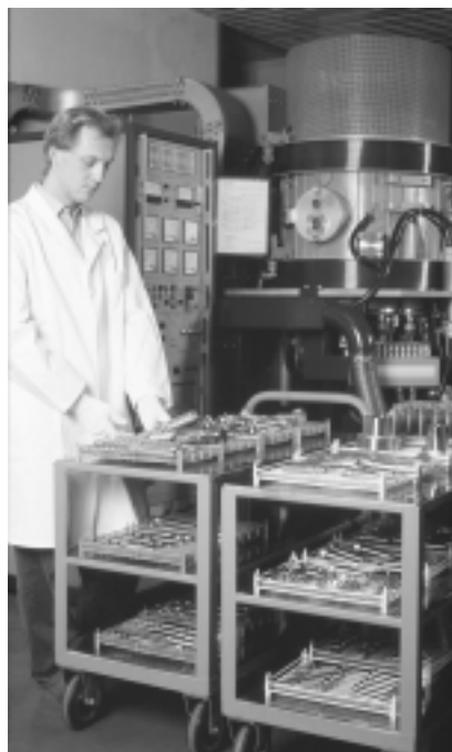
Slika 2: Prva naprava za nanos trdih prevlek (BAI 730) v Centru za trde prevleke, ki jo je kupilo podjetje Smelt. Ob napravi stoji Damjan Matelič, ki v Centru že dvajset let nanaša trde prevleke na orodja in strojne dele.
