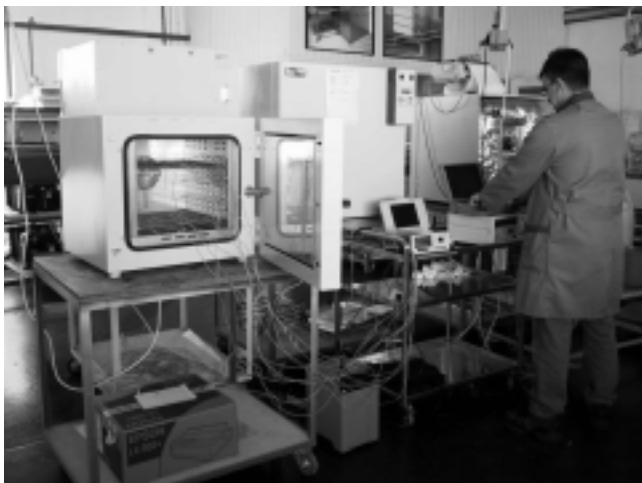
Slika 3: Preden pošljejo novo napravo kupcu, naredijo validacijo njenih procesnih parametrov
