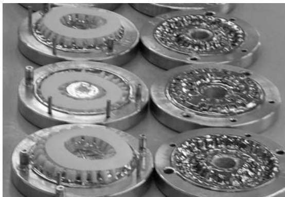
Slika 4: Matrice iz elektrolitskega niklja, zaščitene s CrN-prevleko, ki jih v podjetju POLIDENT iz Volčje Drage pri Novi Gorici uporabljajo za izdelavo umetnih zob iz polimetilmetakrilata. Prevleka bistveno poveča obstojnost in zmanjša sprijemanje.
