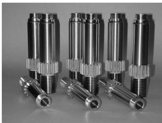
Slika 4: Matrice iz elektrolitskega niklja, zaščitene s CrN-prevleko, ki jih v podjetju POLIDENT iz Volčje Drage pri Novi Gorici uporabljajo za izdelavo umetnih zob iz polimetilmetakrilata. Prevleka bistveno poveča obstojnost in zmanjša sprijemanje.
