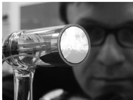
Slika 3: Večplastno prevleko CrN/TiAlN (na sliki) so naredili v Centru za trde prevleke na Institutu "Jožef Stefan", kjer sodelujejo z več kot 150 industrijskimi partnerji iz Slovenije in tujine. Večplastne prevleke so primerne za različna področja uporabe, saj imajo v splošnem večjo trdoto in so bolj žilave od enoplastnih prevlek.
