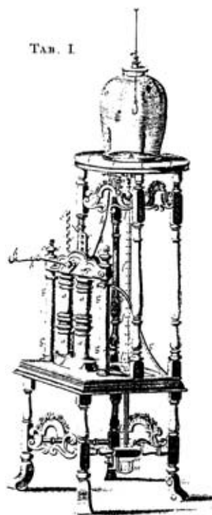
Slika 2: Hauksbeejeva vakuumška črpalka iz leta 1719 (Hauksbee, 1719, Tab. I.)
