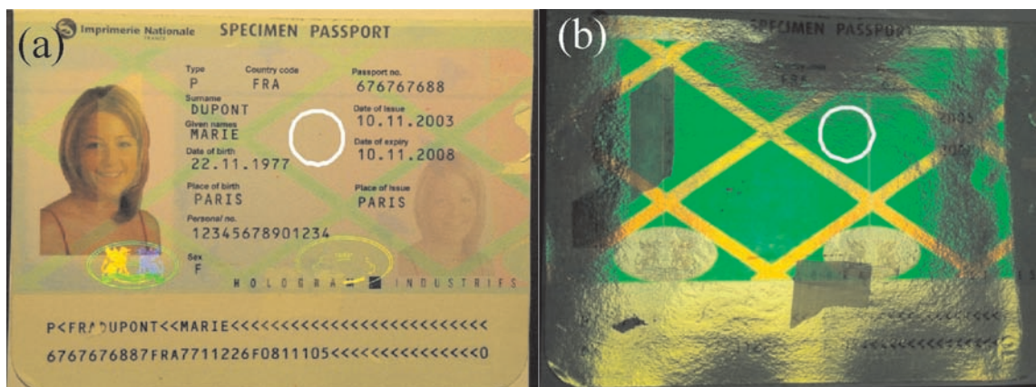
Slika 10: Fotografski posnetek vzorčnega dokumenta z zaščitno folijo Optoseal. Približno pravokotno na vzorec vidimo vsebino dokumenta (a), pri velikem vpadnem kotu pa dokument zakriva kotno zelo široka uklonska barva (b). Krog označuje mesto merjenja. Na temnih mestih slike (b) je prilepljen prosojni lepilni trak, ki preprečuje uklon svetlobe, pri pravokotnem gledanju (a) pa ga ne opazimo.
