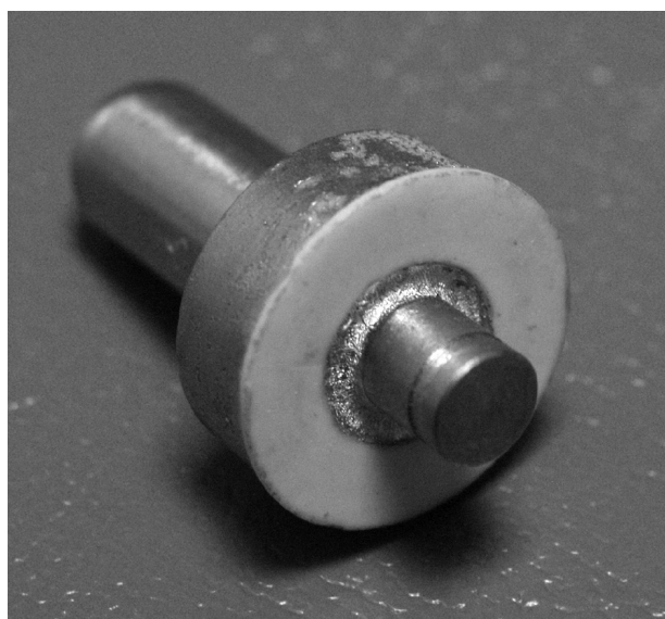
Slika 6: Molibdenska elektroda ( D = 6 mm), spajkana z bakrom v keramični izolator plinskega prenapetostnega odvodnika
