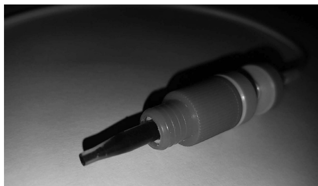
Slika 1: Ogljikova pasta in nosilec tipa PE.W4.E1 proizvajalca BVT Technologies (Brno, Češka)
